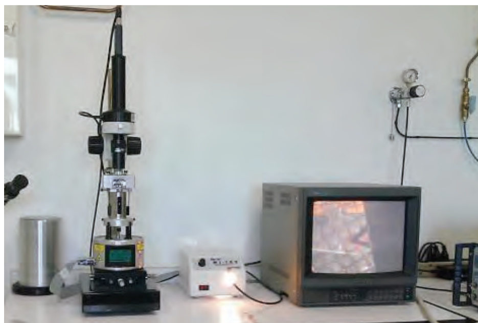
Microscope à force atomique permettant de sonder des surfaces à l'échelle moléculaire.
