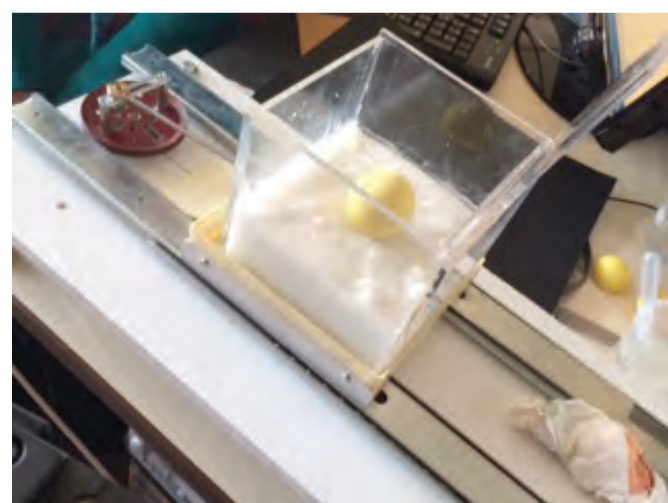
Dispositif expérimental modélisant l’effet des séismes sur les bâtiments. Le sol est représenté ici par un sable artificiel à base de polystyrène et un bâtiment par une boule jaune.
