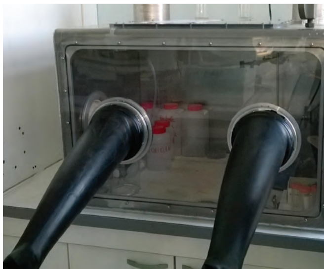
Une boîte à gants permettant des expériences sous atmosphère contrôlée.
