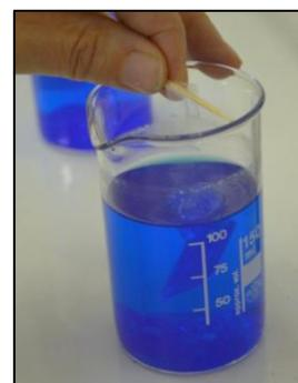
Trempe d'un cristal dans une solution sursaturée. © JDS
